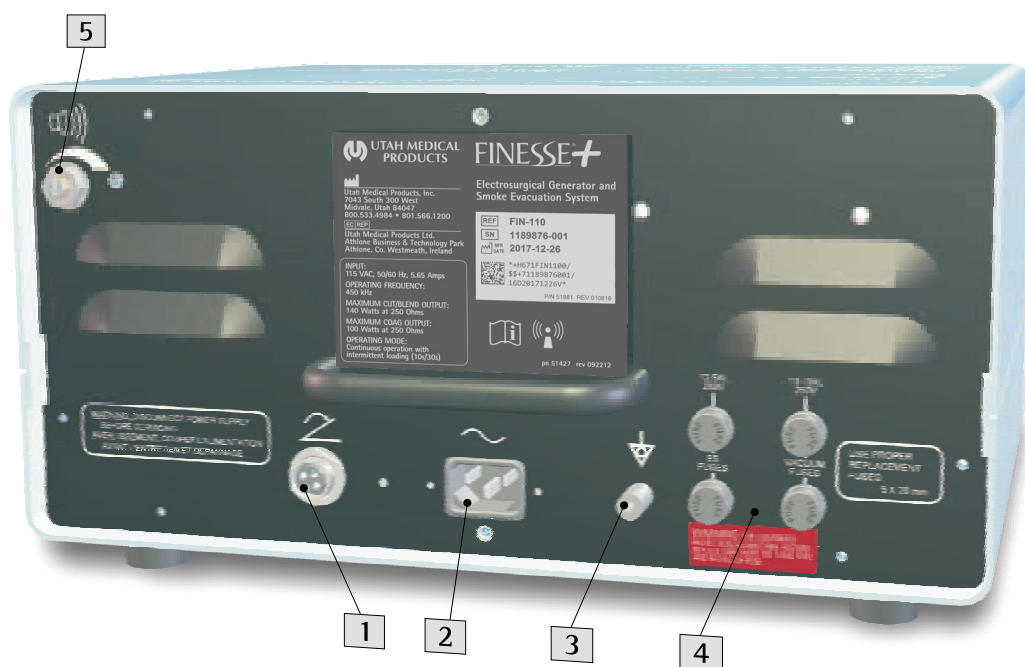
Bild 4. FINESSE+ baksida - anslutningar och kontroller
